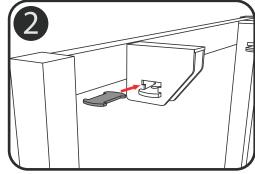
Montar la placa lisa sobre la placa perforada, repetir el paso en los 4 soportes.
