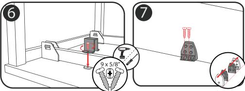
Situar la pieza Omega sobre el Suple, alineando ambas perforaciones y atornillar por sus ambos lados.
