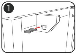
Insertar las placas de fijación perforadas en los orificios laterales de los 4 soportes.
