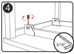
Voltear la estructura métalica con las patas hacia arriba sobre la cubierta de madera y fijar los pernos con una llave Allen.
