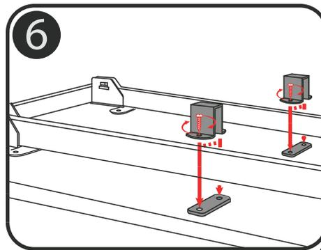
Situar la pieza Omega sobre el Suple, alineando ambas perforaciones y atornillar por sus ambos lados.
