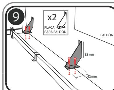
Atornillar las placas sobre la cubierta a 10 cm. del borde del faldón.
