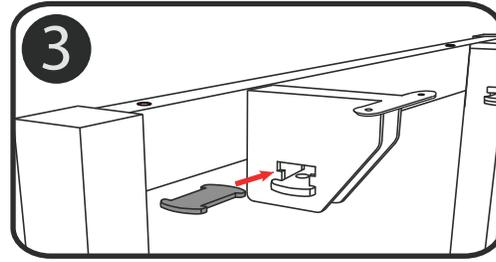
Montar la placa lisa sobre la placa perforada, repetir el paso en los 4 soportes.
