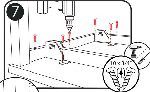
Atornillar la estructura con la cubierta con ayuda de un atornillador, dejando 1cm de separación de la cubierta con la estructura.
