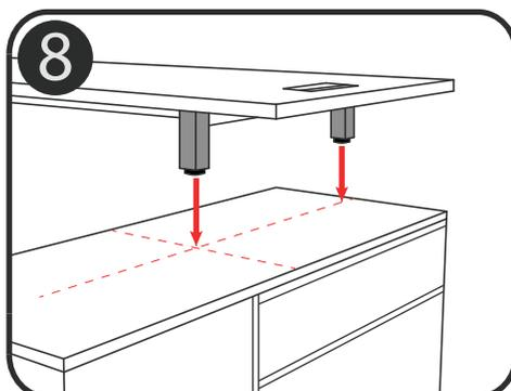
Ubicar las patas cortas sobre el gabinete, tal como se muestra en la ilustración.
