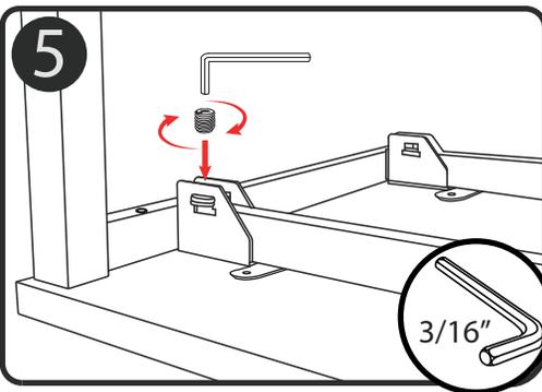
Voltear la estructura metálica con las patas hacia arriba sobre la cubierta de madera y fijar los pernos con una llave Allen.
