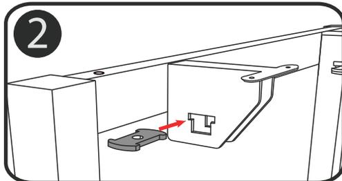
Insertar las placas de fijación perforadas en los orificios laterales de los 4 soportes.
