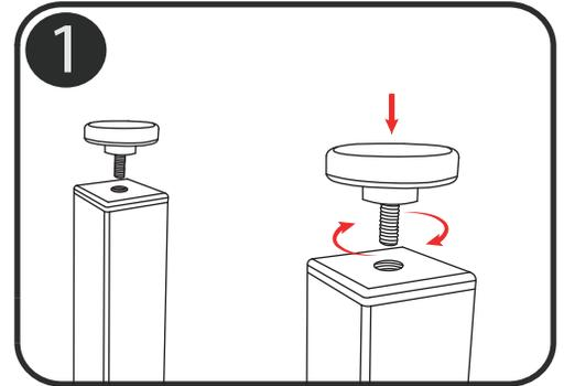
Ubicar los ejes de los patines en los hilos de los 4 insertos de cada pata y atornillar manualmente hasta el tope.
